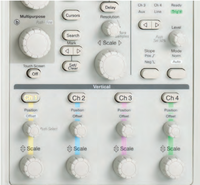
Abbildung 60. Konventionelle analoge Drehknöpfe zum Einstellen von Position, Skala, Intensität usw. – mit der erwarteten Genauigkeit.
