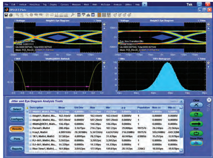
Abbildung 54. Analyse-Softwarepakete wurden speziell für die Anforderungen von Jitter- und Augendiagramm-Messungen bei modernen Hochgeschwindigkeits-Digitalschaltungen konzipiert.
