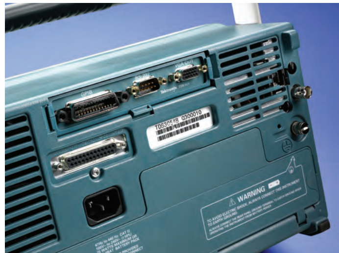
Abbildung 53. Moderne Oszilloskope verfügen über eine Vielfalt von Kommunikationsschnittstellen, wie z. B. einen standardmäßigen Centronics-Anschluss und optionale Ethernet/RS-232-, GPIB/RS-232- und VGA/RS-232-Module. Auf dem vorderen Bedienfeld befindet sich sogar ein USB-Anschluss (nicht dargestellt).
