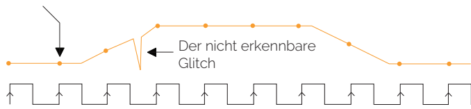
Abbildung 23. Die Abtastrate ändert sich mit den Zeitbasis-Einstellungen – je langsamer die Zeitbasis-Einstellung, desto langsamer die Abtastrate. Einige digitale Oszilloskope bieten einen Spitzenwerverfassungsmodus zum Erfassen schneller Transienten bei niedrigen Ablenkgeschwindigkeiten.
