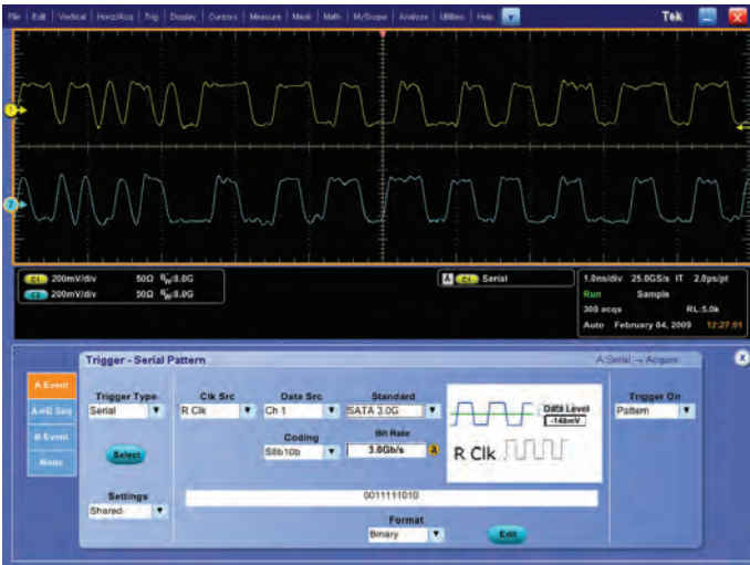
Abbildung 49. Ein DPO ist ideal geeignet für nicht repetitive Hochgeschwindigkeits- und Mehrkanalanwendungen bei Digitalschaltungen.
