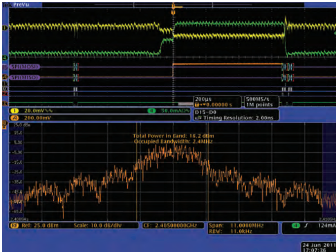
Abbildung 16. Zeitkorrelierte Darstellung der Mikroprozessor-SPI-Steuereleitungen (MOSI und MISO) eines Zigbee-Funkgeräts, mit Messungen des Drainstroms und der -spannung für die Funkgeräteschaltung und das Spektrum beim Einschalten.
