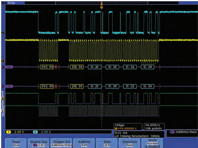
Abbildung 55. Die serielle Busanalyse wird durch automatisierte Triggerng, Dekodierung und Suche im Kontext serieller Pakete beschleunigt.
