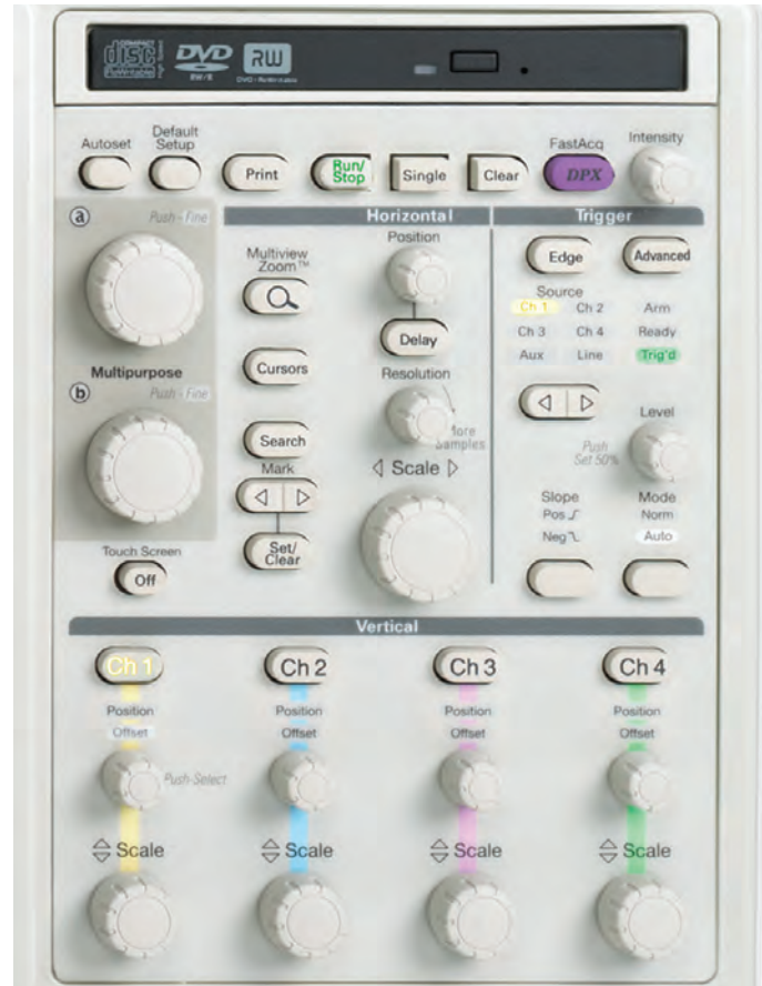
Abbildung 20. Bedienelemente auf dem vorderen Bedienfeld eines Oszilloskops.
