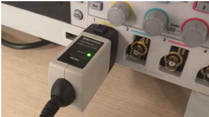
TekVPI 探棒將刻度設定、範圍和狀態傳達給 TBS2000B。
