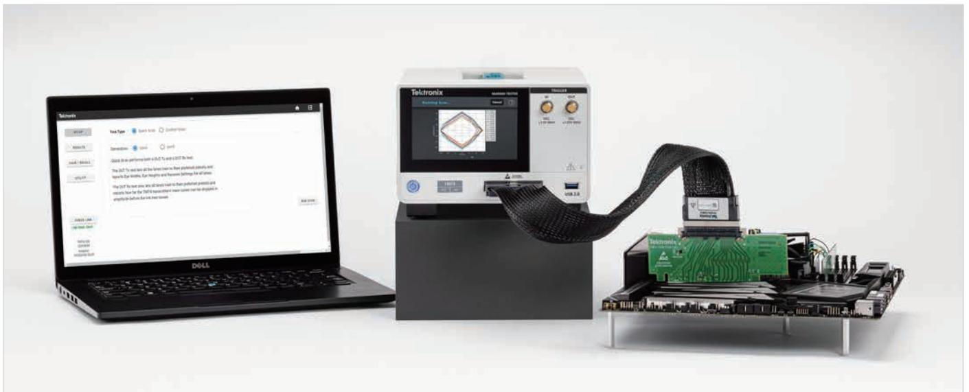
図5. TMT4型マージン・テスト (中央)、CEMエッジ・アダプタ (右)、PCでネットワーク・アクセスした結果の表示 (左)
