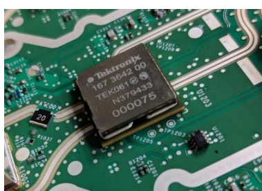
図 4b: テクトロニクスの新しいアナログ・アンプ ASIC (TEK061)
