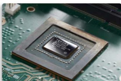
図 4a: テクトロニクスの新しい 12 ビット ASIC (TEK049)
