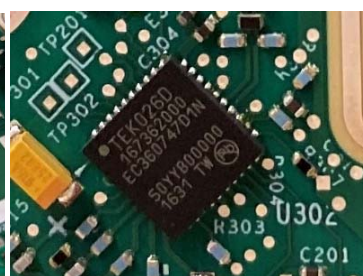
図 4c: テクトロニクスの新しいフロントエンド ASIC (TEK026D)
