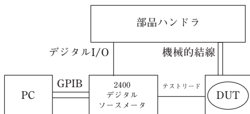
図2. 2400型をベースとしたバリスタ製造試験システム
