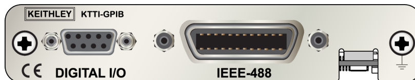
図21：KTTI-GPIB コネクタ
