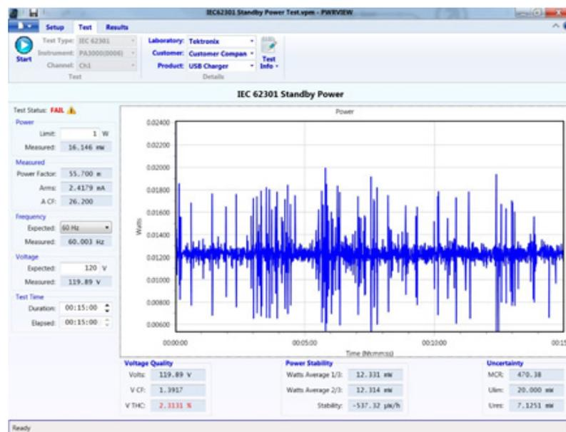
Figura 56: Teste de energia em standby em conformidade total com a IEC 62301
