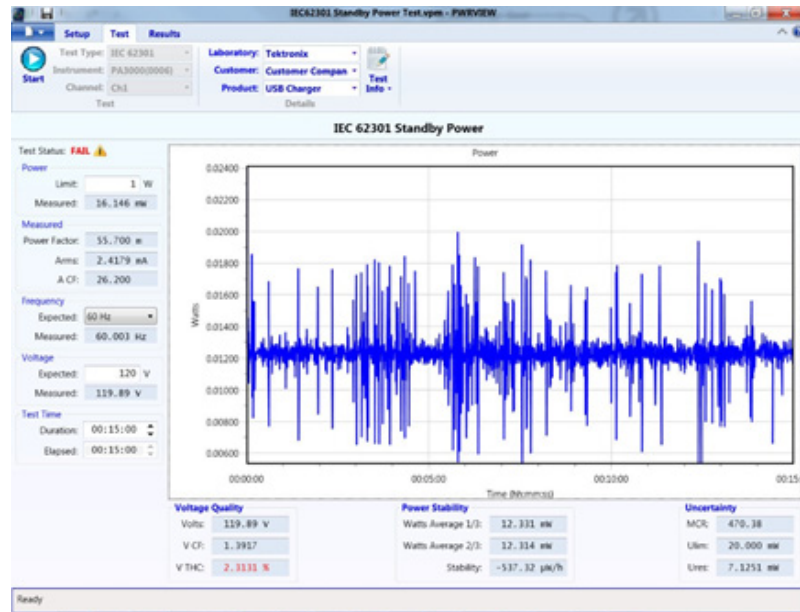
図 56: IEC 62301 準拠の待機電力完全適合性試験
