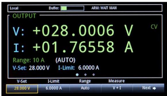
上圖顯示電源供應器功能的首頁畫面。您可以在啟動畫面上選擇電源供應器功能來進入此畫面。
