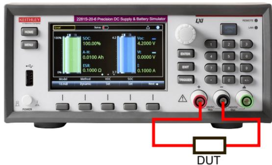
下圖顯示 DUT 與后面板的雙線 ( 本機感應 ) 連接。
