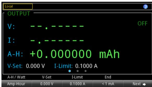
上圖顯示電池測試功能的首頁畫面。
