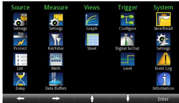
Desde esta pantalla, puede seleccionar los menús Source (Fuente), Measure (Medidas), Views (Vistas), Trigger (Disparo) y System (Configuración del sistema). Estos menús le permiten configurar el instrumento para sus aplicaciones. Seleccione un elemento del menú desplazándose con el control de navegación o utilizando las teclas de flechas para marcar un icono. Seguidamente, pulse **ENTER** para confirmar.
