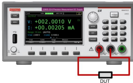
La siguiente ilustración muestra las conexiones de dos hilos del DUT (detección local) del panel posterior.
