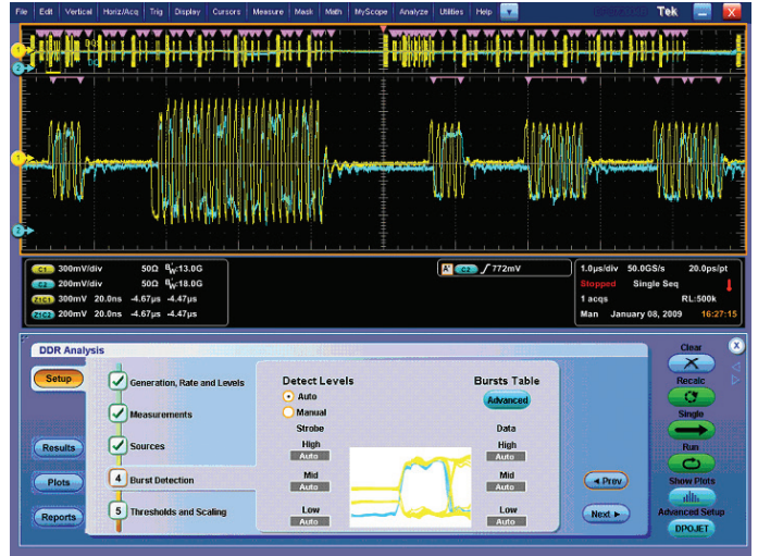
Figure 57. Les outils d'analyse DDR avancés automatisent les tâches complexes comme la séparation des rafales en lecture/écriture et les mesures JEDEC.
