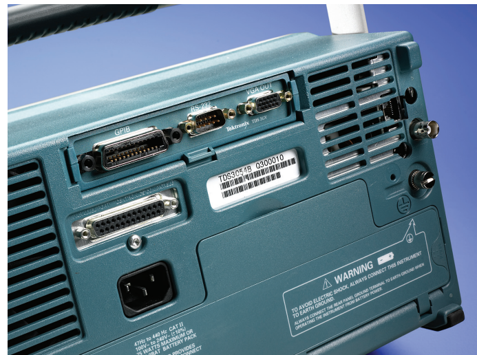
Figure 53. Les oscilloscopes actuels offrent de nombreuses interfaces de communication, comme le port standard Centronics et des modules optionnels Ethernet/RS-232, GPIB/RS-232, et VGA/RS-232. Il existe même un port USB (non visible sur l'illustration) sur le panneau avant.
