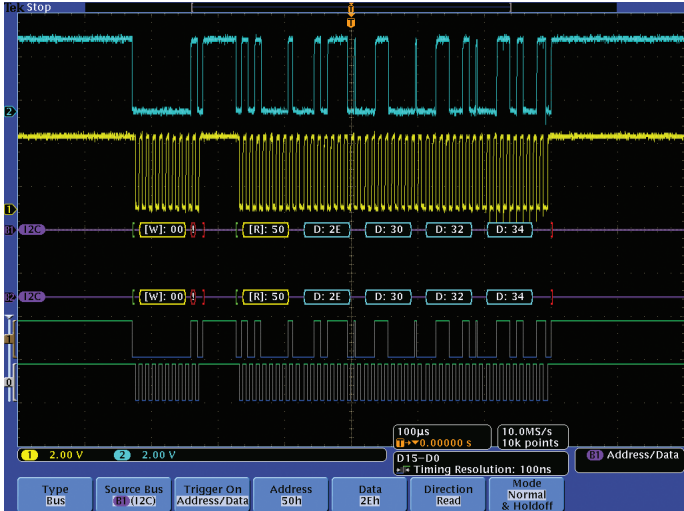
Figure 55. L'analyse du bus série est facilitée par l'automatisation du déclenchement, du décodage et de la recherche sur le contexte des paquets série.
