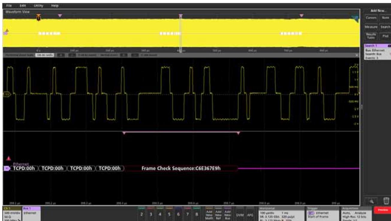
上面解码后的总线画面显示，共捕获了三个总线活动突发。如果想找到活动中的具体值，可以使用 Wave Inspector 自动搜索功能，标记每个指定的事件。在本例中，自动总线搜索配置成查找所有 Frame Check Sequence( 帧校验序列 ) 错误，显示了 3 个事件，位于每个总线活动突发的最后。
