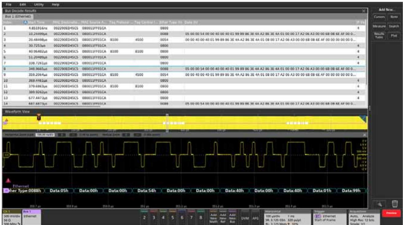
对解码后的信息增加 Results Table 视图，提供了总线活动带时间标记的显示画面，可以与软件列表简便对比。触击 Results Table 中的一行，示波器会自动放大对应的总线信号及得到的解码后的总线波形，显示在屏幕下方。
