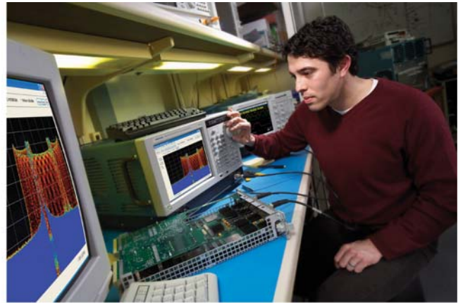
图43. DPX 频谱画面提供了在频域中随时间变化的瞬态信号的直观实时颜色视图，您可以对自己的设计稳定性树立信心，或在发生时立即显示问题。
