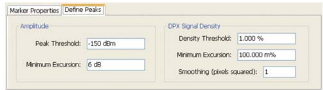
图 30. 可以选择 Amplitude 和 Signal Density 控制功能，定义 Peak 信号。
