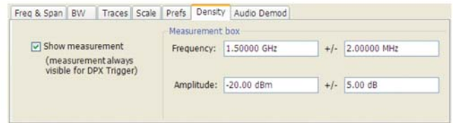
图 32. DPX Density 控制面板用来定义 DPX 密度测量关心的区域。
